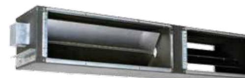
Il kit Econofresh, che è disponibile per la gamma Utopia, è in grado di garantire fino al 100% di aspirazione di aria esterna e, tramite serrande, può fare funzionare l'apparecchio in modalità free cooling quando la temperatura esterna è inferiore alla temperatura ambiente desiderata. È abbinabile solo al modello Canalizzabile RPI 5 FSN4E.
